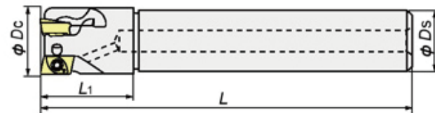
Fig-2 アンダーカット形 Undercut type
